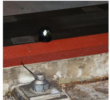
Detalle del Track o carril por donde se desplaza la antena, e imagen del prisma para industria utilizado para la medición
